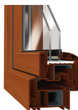
Verglasungspaket 2-Scheiben 24 mm Ug 1,0/Wm 2 K Distanzrahmen swisspacer V, Argon
