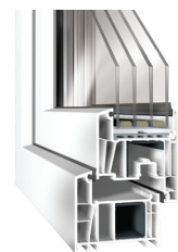
Verglasungspaket 4-Scheiben 52 mm Ug 0,3/Wm 2 K Distanzrahmen swisspacer Ultimate, Krypton
