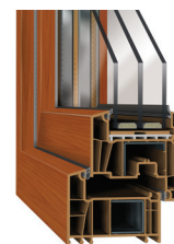
Verglasungspaket 3-Scheiben 48 mm Ug 0,5/Wm 2 K Distanzrahmen swisspacer V, Argon
